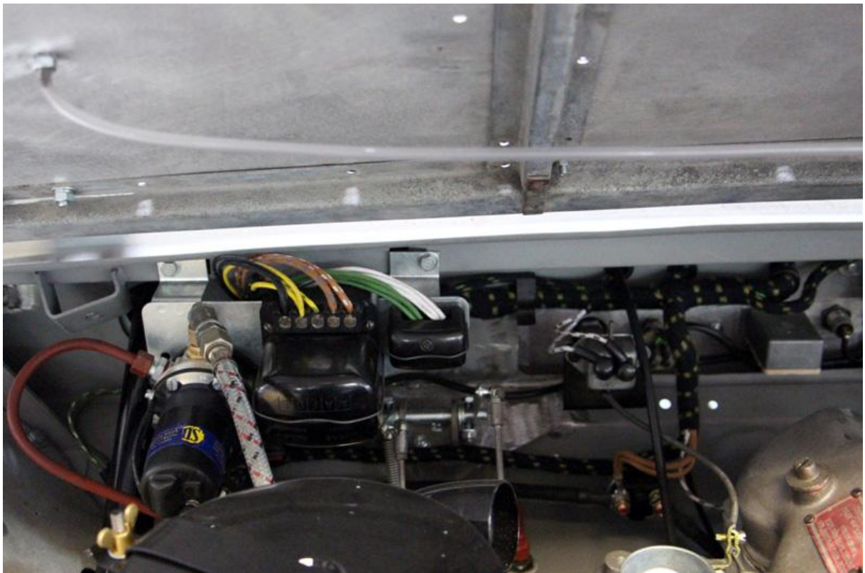
Die Hupe hängt an der Motorhaube. Der Kabelbaum ist neu.
