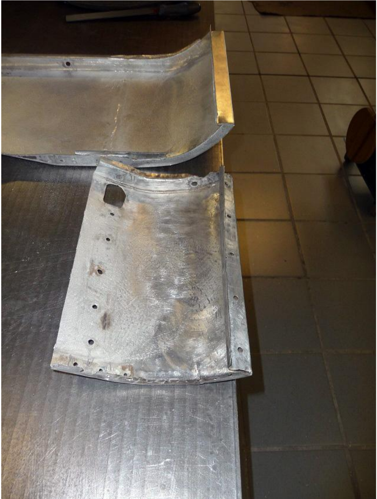
Die Rundungen werden aus neuem Alublech exakt nachgebildet...
