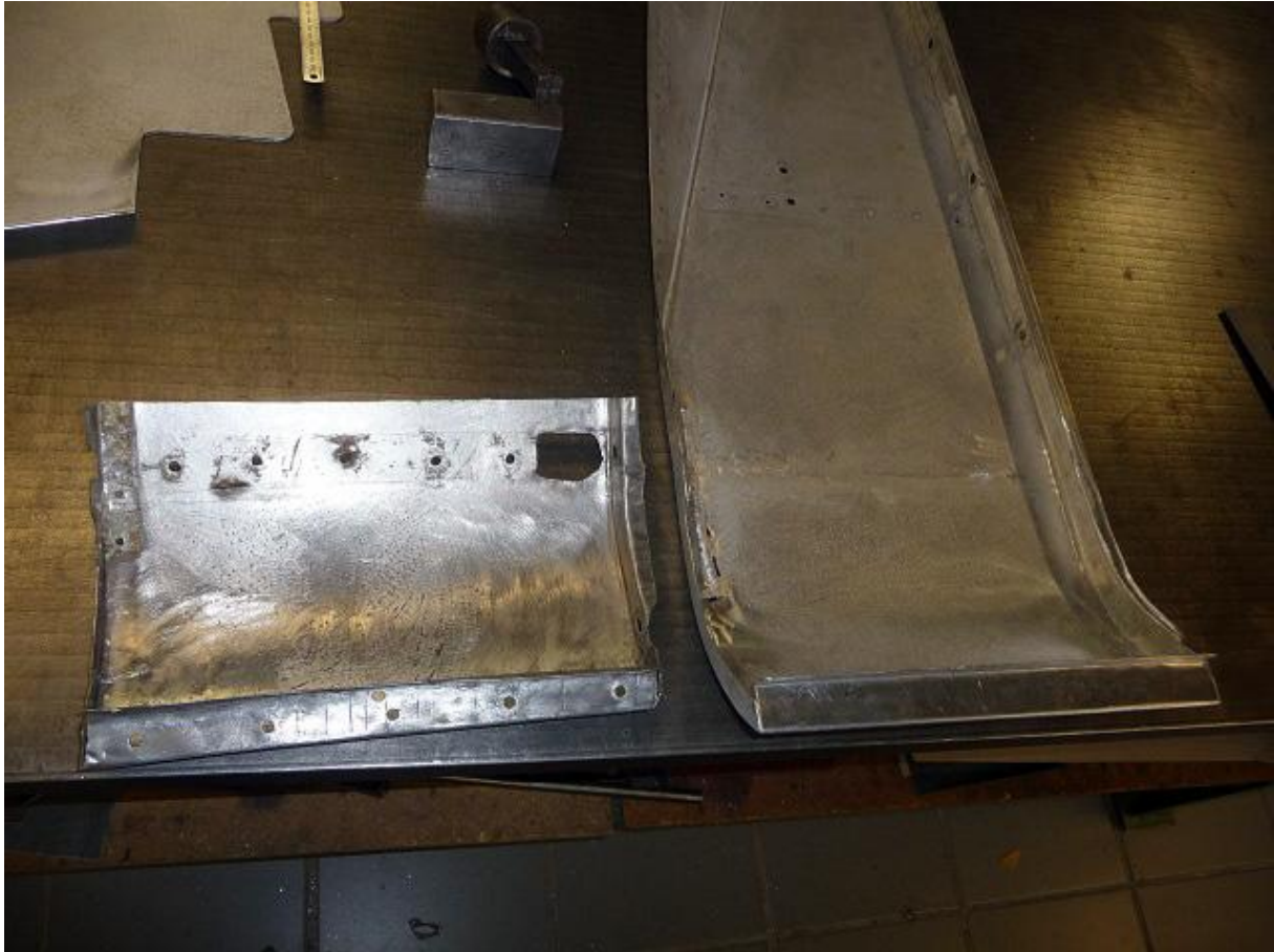
Die Kotflügel Oberteile sind relativ "verbraucht" und werden aufwendig überarbeitet.
