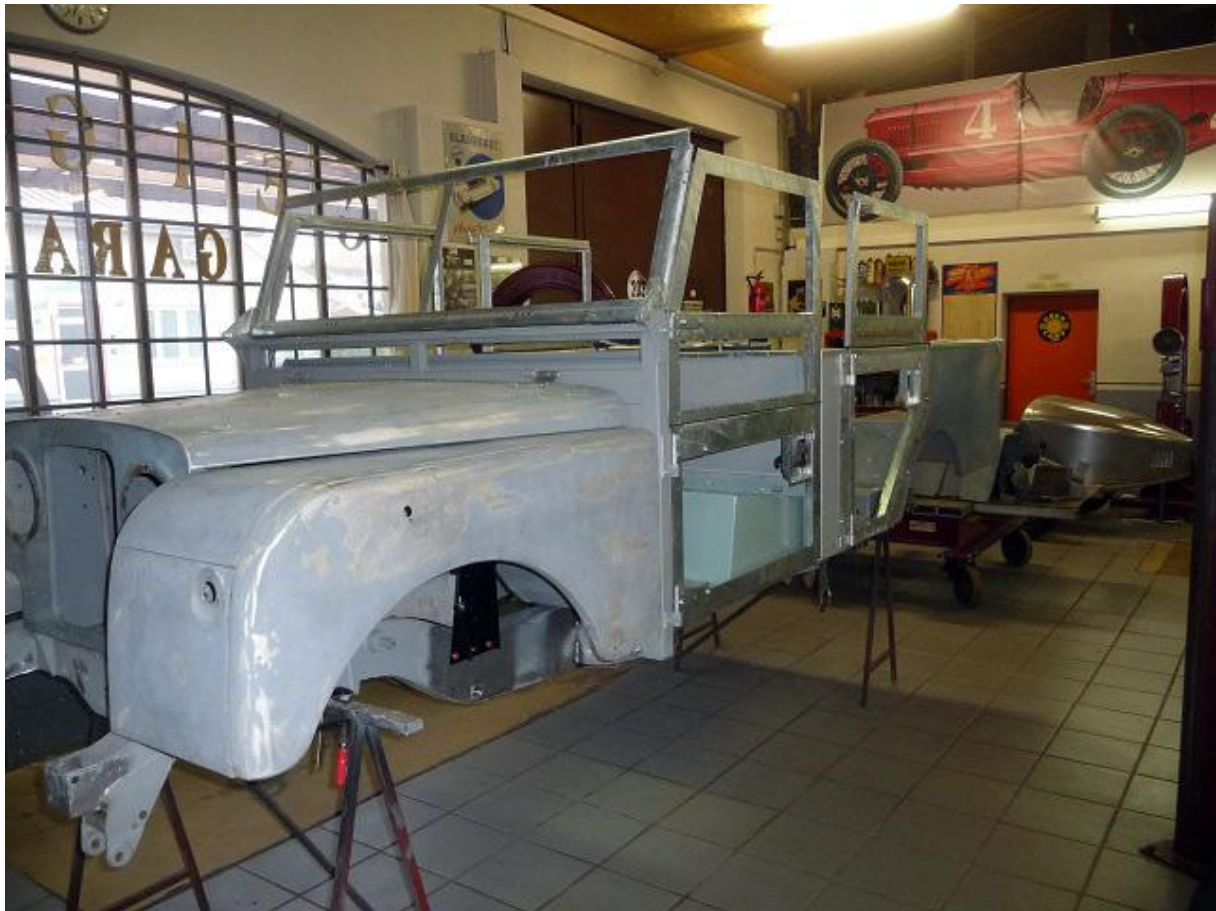
Die Türen sind noch ohne Beplankung.
