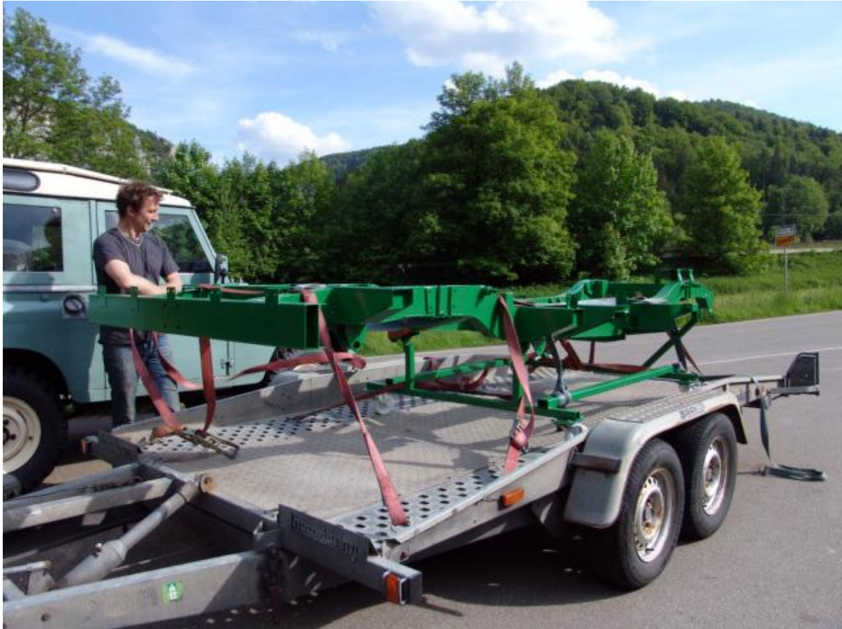
Hier kommt der Rahmen vom Sandstrahlen...
