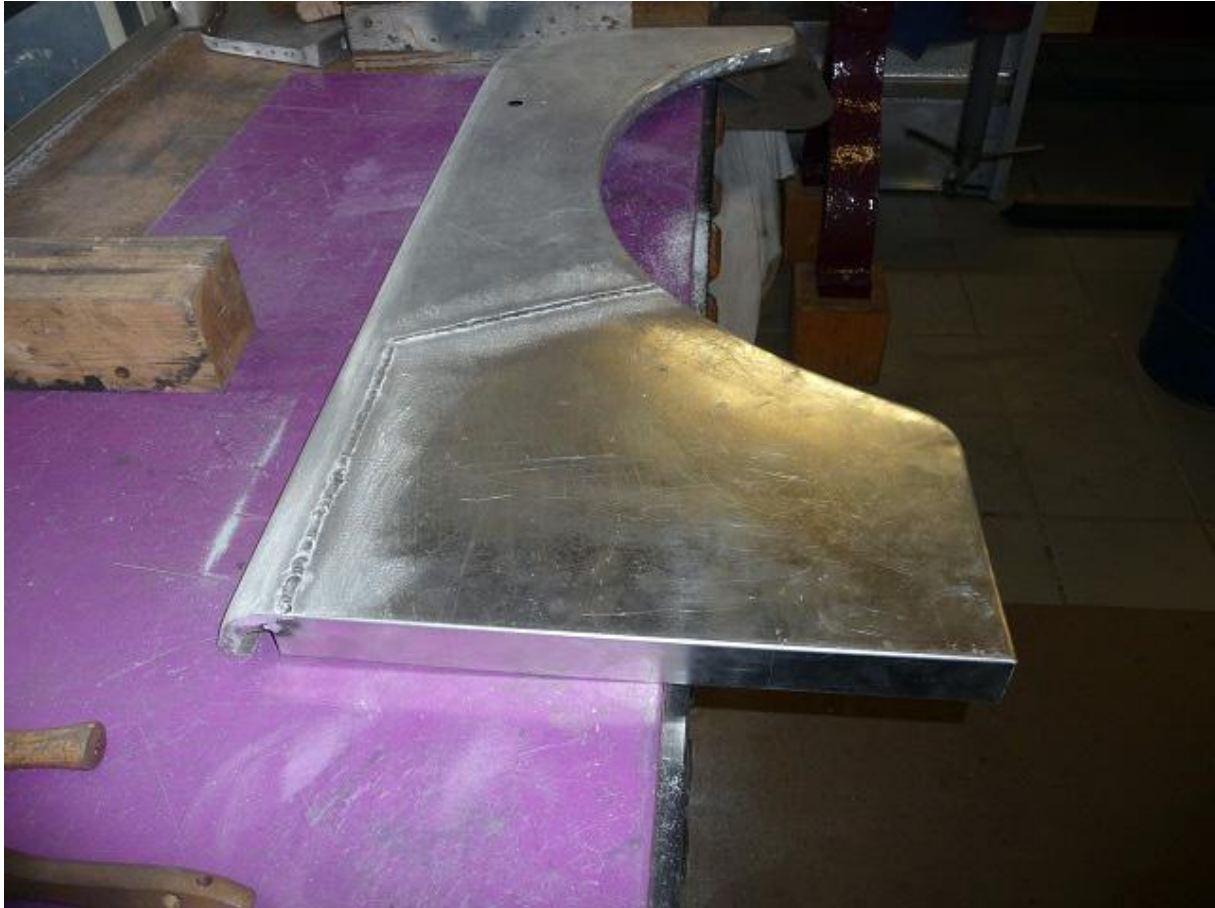
An den Außenhäuten der Kotflügel wird der hintere Teil ersetzt.
