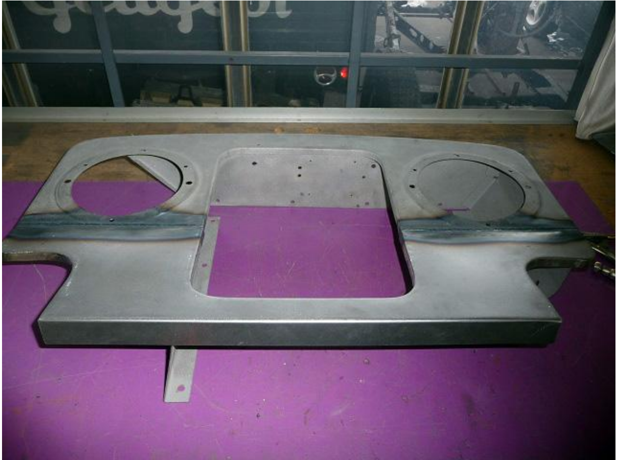
Das neue Unterteil wurde angeschweißt.
